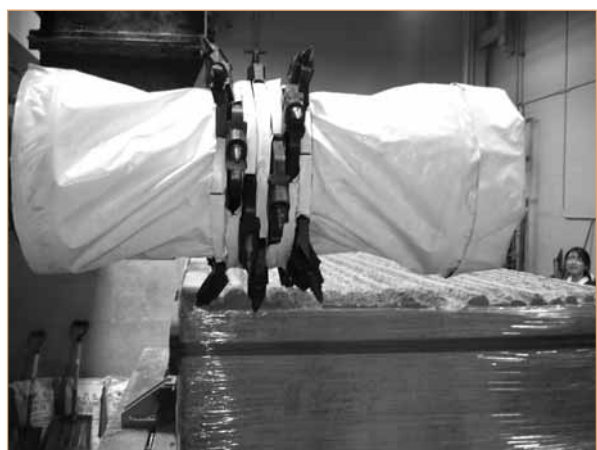
شکل (۷) - آزمایش برش دورانی با کله‌ی حفاری جدید (چپ) و کله‌ی حفاری صلب (راست)
