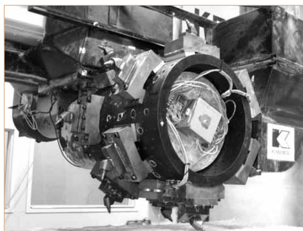
شکل (۷) - آزمایش برش دورانی با کله‌ی حفاری جدید (چپ) و کله‌ی حفاری صلب (راست)
